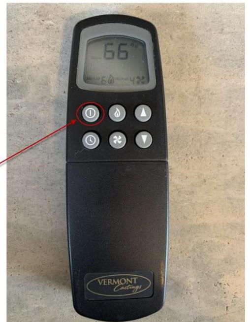
Étape #2 : Si le Pilote est Allumé, il ne vous suffit que de d'allumer le foyer en utilisant la manette en appuyant sur le bouton en haut a gauche. Veuillez noter que si le foyer ne s'allume pas avec la manette il se peut que le foyer soit en mode "local" , referez vous a la section B : "Allumer le Pilote".
